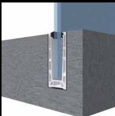
Sapata em U embutida na laje
