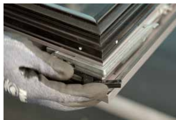
Suppression de l'épointage de l'ouvrant : moins d'opérations d'usinage
