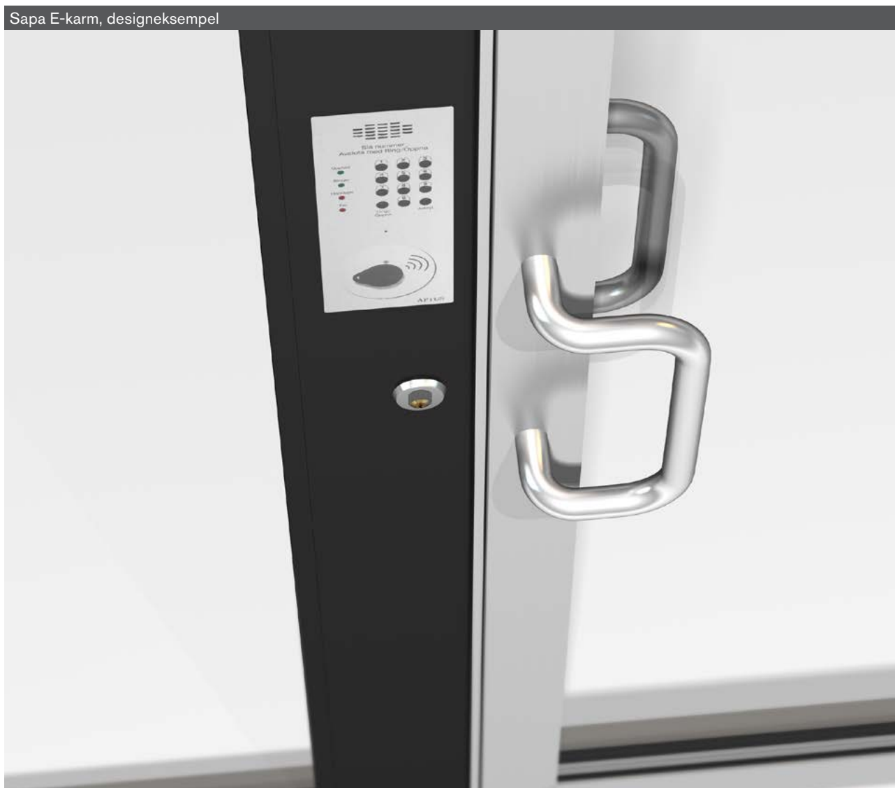
Indgangsdør med dørtelefon/adgangssystem. Dør 2074 naturanodiseret og karme 3074 pulverlakerede. Lås monteret i karm. Forstærket anslagsprofil.
