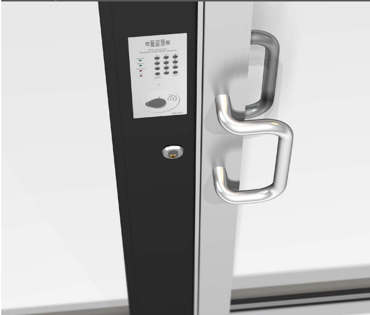
Inngangsparti med porttelefon/adgangskontrollsystem. Dør 2074 naturanodisert og karm 3074 pulverlakkert. Lås montert i karm. Forsterket anslagsprofil.
